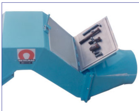
Abertura da Placa Magnética para a limpeza das impurezas ferrosas capturadas
