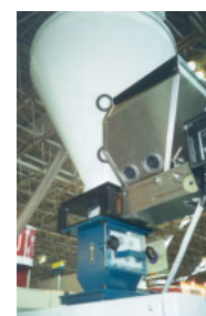
Grade instalada em injetora de plástico
