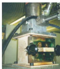
Grade instalada em extrusora de plástico
