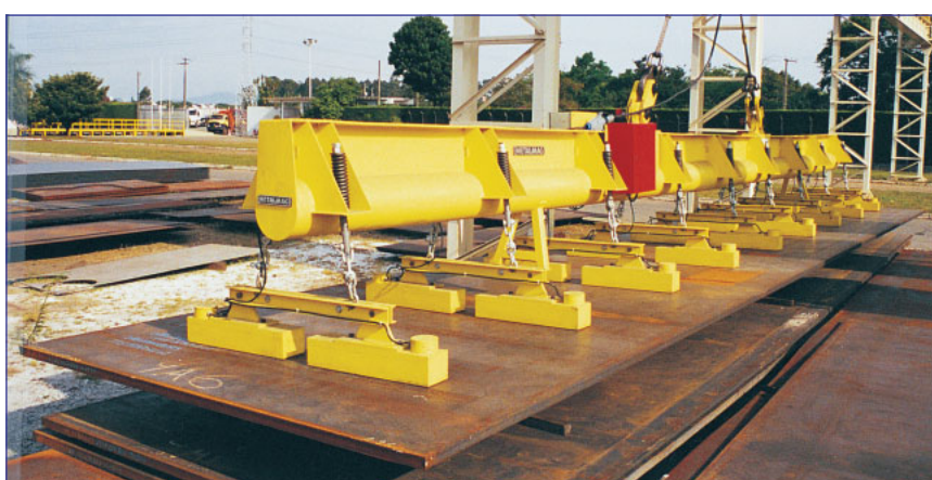
Aplicação típica de Levantadores Eletro-Permanentes utilizados em conjunto
