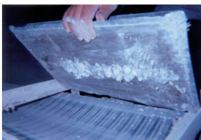
Impurezas ferrosas capturadas. A dobradiça facilita a operação de limpeza
