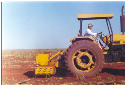
Suspensão Magnética em posição de trabalho em canalial, após a colheita
