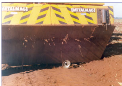
Operação da "chapa limpadora" para a limpeza das impurezas ferrosas capturadas
