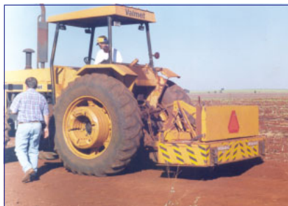
O grande alcance do campo magnético permite que o Suspenso fique distante do solo quando este é muito acidentado
