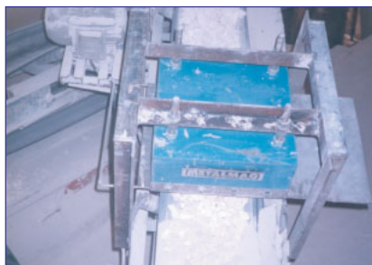
Vista superior de opção típica e mais usual de instalação: Posição 2 - Transversal
