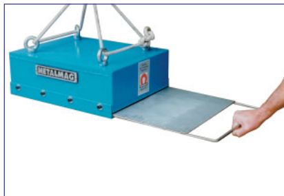
Operação da "gaveta limpadora" para a limpeza das impurezas ferrosas capturadas
